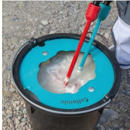
Den verschmutzten Rührer zwischen die Bürsten tauchen, dabei den Rührer langsam drehen lassen, bis vollständig eingetaucht. Um eine gründliche Reinigung zu erzielen, den Rührer während des Drehens leicht schräg halten.
