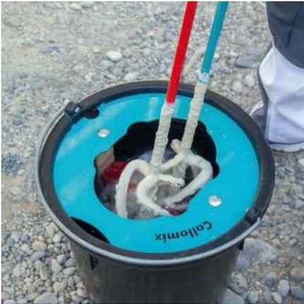
Nach dem Mischen, den Rührer mit dem noch frisch anhaftenden Material mit dem Mixer-Clean reinigen. Mixer-Clean bis etwa Oberkante der Bürsten mit Wasser füllen.
