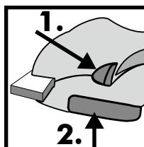
Makineyi daima iki elinizle tutun. Çalıştırma blokajı düğmesine basın (1).
