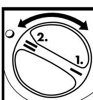
Pentru schimbarea dintr-o viteză în alta, roțiți maneta de schimbare a vitezei la 180°.
