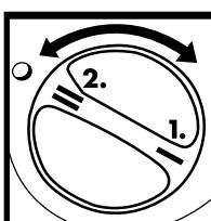
Ställ in reducerat varvtal när blandningsverktyget sänks ned i resp. lyfts upp ur materialet. Efter att blandningsverktyget har sänkts ned helt i material kan varvtalet höjas till maximal nivå så att motorn kyls i tillräcklig mån.
