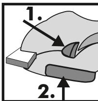
Придържайте винаги машината с две ръце. Натиснете бутона на блокировката спрямо включване (1).
