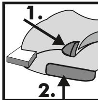
Pritisnite sklopku za UKLJUČIVANJE/ISKLJUČIVANJE (2).
