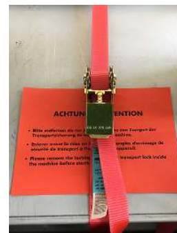
Transportsicherung mit Zurring
